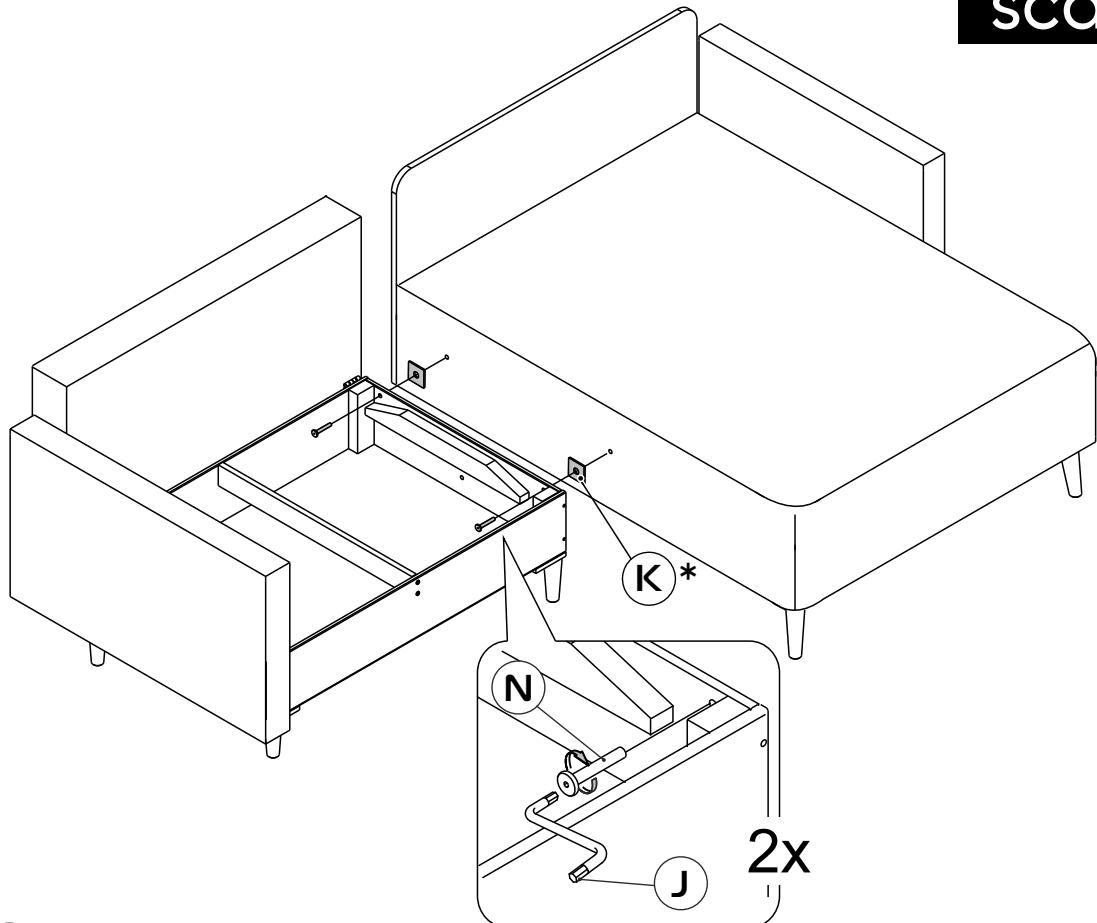
\*поз. K устанавливать при необходимости (для улучшения кинематики раскладывания)
