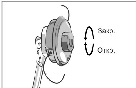
6.8.2 Установите внутренний фланец (а) на вал. Удерживая фиксатор выходного вала наверните катушку с леской на вал против часовой стрелки.
