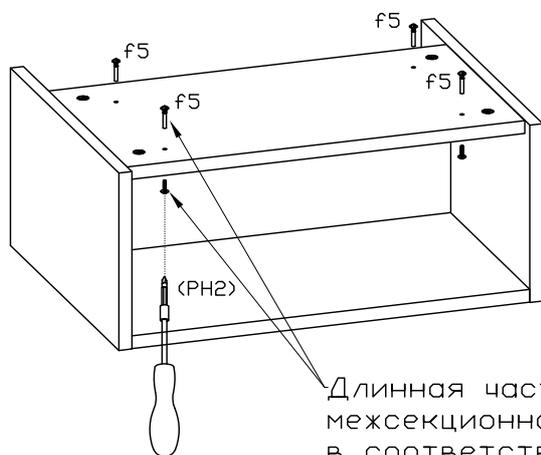
Длинная часть (гильза) межсекционной стяжки вставляется в соответствующее сквозное отверстие шкафа КИТО и забивается до упора молотком. Винт вкручивается со стороны присоединяемой детали при помощи отвертки (бита PH2)
