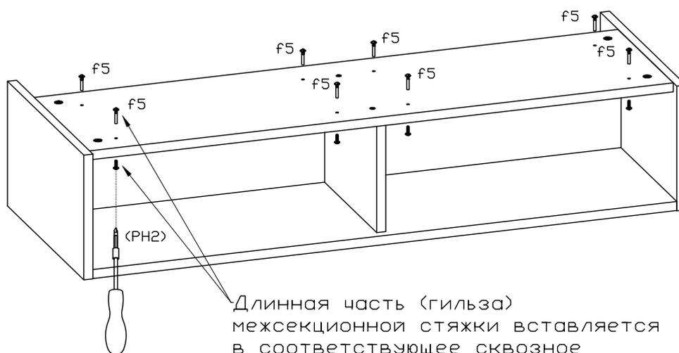
Длинная часть (гильза) межсекционной стяжки вставляется в соответствующее сквозное отверстие шкафа КИТО и забивается до упора молотком. Винт вкручивается со стороны присоединяемой детали при помощи отвертки (бита PH2)
