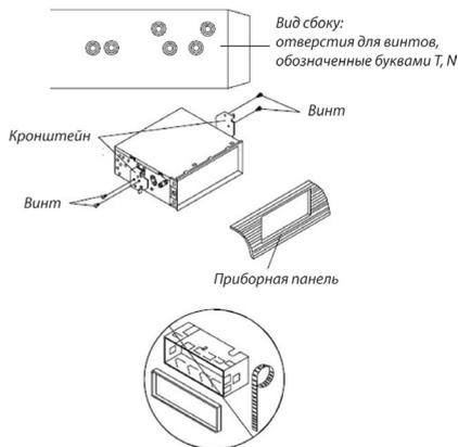
Выберите позицию, при которой винтовые отверстия кронштейнов, закрепленных в автомобиле, и винтовые отверстия приемника, отмеченные соответствующими буквами названия марки автомобиля, совпадут, и закрепите проигрыватель с каждой стороны при помощи 2-х винтов 5x5 мм.
