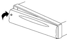
Если передняя панель закреплена неправильно, на экране отобразится сообщение об ошибке или некоторые кнопки не будут работать.
