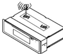
Перед началом установки выкрутите два винта, служащих для предотвращения повреждений механизма воспроизведения дисков. Не загружайте в устройство диск, если винты не были выкручены.
