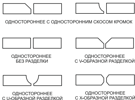
Рис. 6 Виды стыковых соединений
