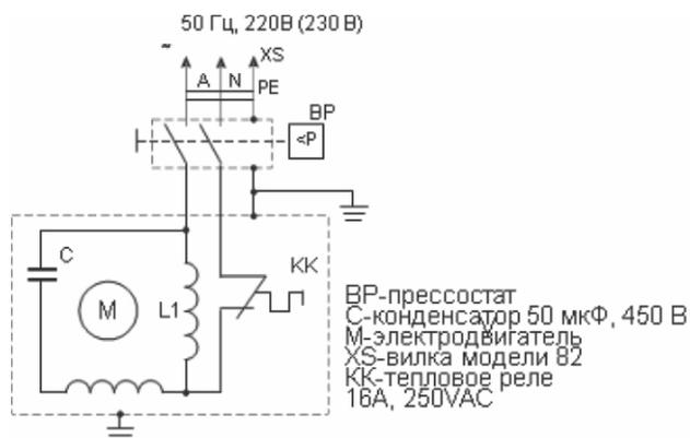
**Схема электрическая принципиальная модели:
