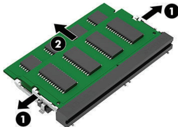
2) Чтобы установить модуль памяти, совместите вырез (1) на новом модуле памяти с выступом в гнезде для модуля памяти. Вставьте модуль памяти в гнездо (2) под углом примерно  $30^{\circ}$  (2), затем нажмите на модуль памяти так, чтобы фиксаторы встали на место (3).
