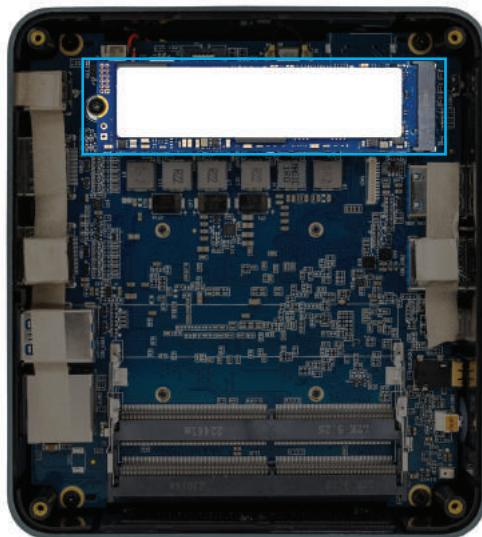
2) Вставьте разъём нового твердотельного накопителя в гнездо на системной плате под углом примерно 30° (1) и закрепите его с помощью винта (2).
