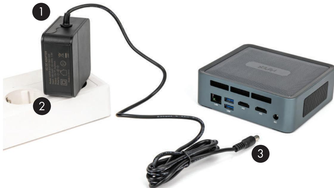
Подсоедините один конец кабеля питания к адаптеру переменного тока (1), а другой конец – к заземлённой электрической розетке (2), затем подсоедините адаптер переменного тока к разъёму питания компьютера (3).
