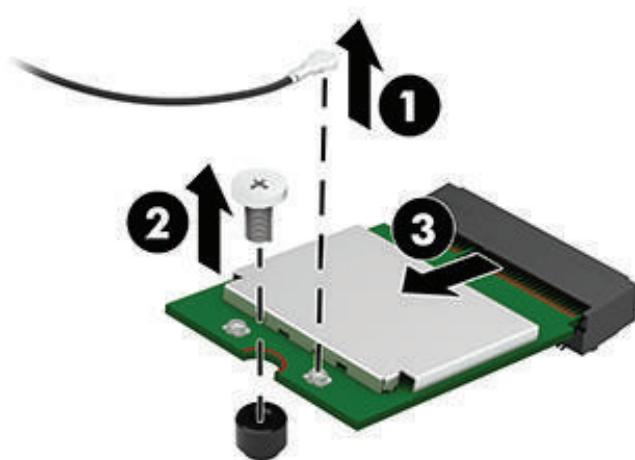
Вставьте до упора новый модуль беспроводной сети в гнездо (1) на системной плате под углом примерно 30°, а затем зафиксируйте его с помощью прилагаемого винта (2). Затем подсоедините антенный кабель (3) к разъему на модуле.
