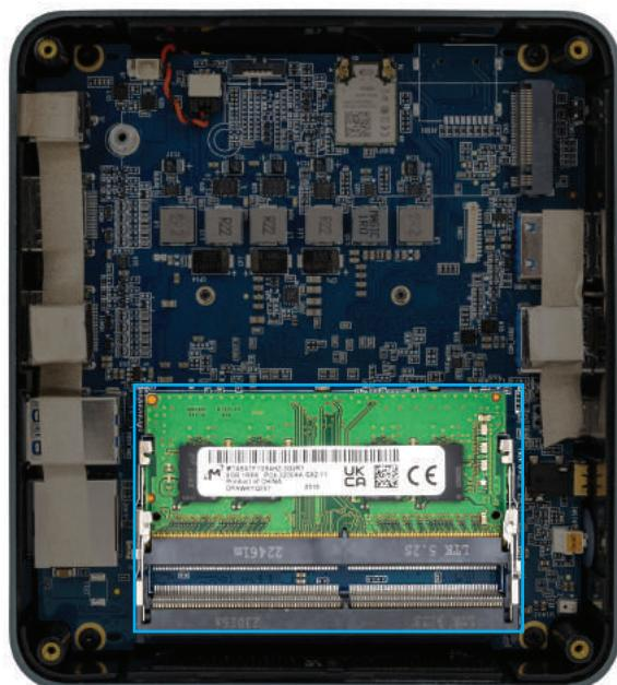
1) Чтобы извлечь модуль памяти, отведите в стороны две защелки (1) по бокам модуля памяти, а затем извлеките модуль памяти из гнезда (2).
