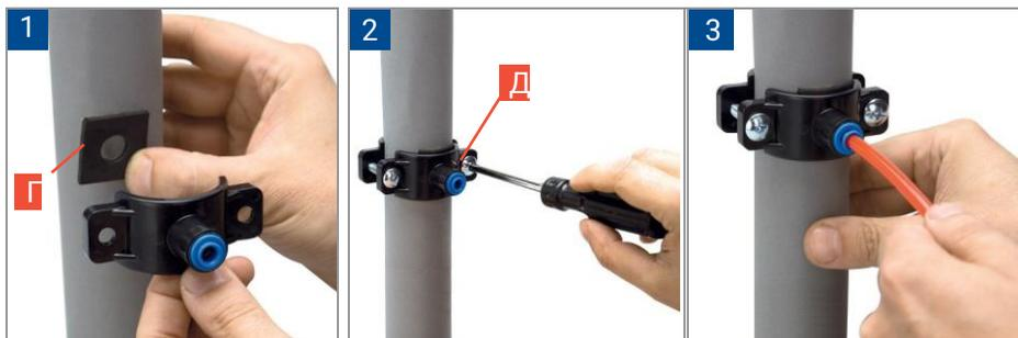
Приклейте прокладку (Г) с внутренней стороны хомута, одновременно совмещая отверстие в прокладке с отверстием в штуцере хомута (рис. 1).
