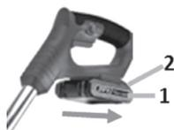
Нажмите на фиксатор (2), чтобы разблокировать батарейный блок (1), затем извлеките его из батарейного отсека.
