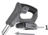
Вставьте батарейный блок (1) в батарейный отсек устройства до упора. Во время фиксации батарейного блока должен раздаваться щелчок.
