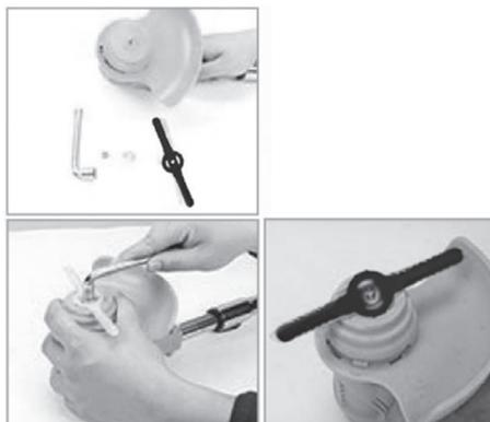
Приложите подходящую насадку к посадочному месту на валу двигателя, затем закрутите крепежный винт ключом.
