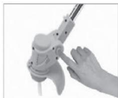
Нажмите кнопку регулировки угла наклона двигателя, чтобы отрегулировать угол наклона.
