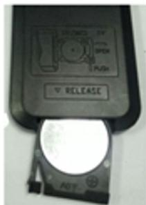
Нажмите на язычок с одной стороны держателя батарейки и вытяните держатель. Установите батарейку с соблюдением полярности и задвиньте держатель до фиксации.
