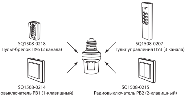
Рисунок 3. Подключение приемников П1-Е27 к пультам и радиовыключателям
