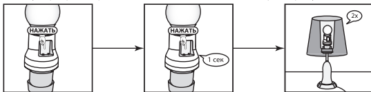
Рисунок 7. Удаление всех кодов из приемника П1-Е27
