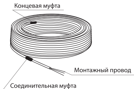
Рисунок 1. Устройство нагревательной секции
