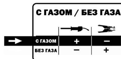
При необходимости сварки самозащитной порошковой проволокой (FLUX) без применения защитных газов подключите кабель выбора полярности (1а) к «-» (отрицательному) сварочному терминалу (5а).
