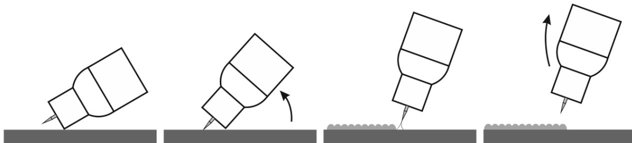
Коснитесь керамическим соплом горелки на свариваемую деталь, располагая горелку под углом и выдерживая при этом расстояние между электродом и деталью примерно 2-3 мм.
