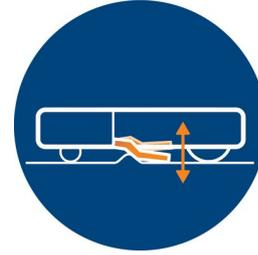
Робот-пылесос оснащен подвижной насадкой, которая повторяет контуры напольного и коврового покрытий для максимально эффективной уборки.
