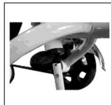
16. Проденьте рычаг управления через раму снизу вверх.
