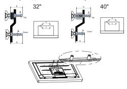
Для крепления ТВ 40" к стене, необходимо установить две цилиндрические втулки к верхним отверстиям крепления VESA.
