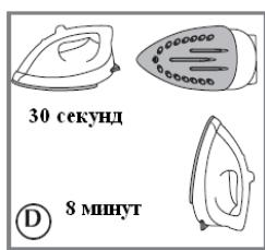
Үтікті автоматты сөндіру функциясы келесідей тәсілмен жүзеге асады: Белгілі бір температурага дейін қыздырылған, бірақ, қолданылмаған үтік, сондай-ақ, табанында жатқан немесе бір қырынан жатқан үтік 30 секундтан кейін автоматты түрде сөнеді. Егер үтік пайдаланылмаса және таяныштіректі тігінен тұрса, - автоматты түрде сөну режимі 8 минуттан кейін қосылады ( D сурет). Үтіктің автоматты отключение қызбаның индикатора жылтынымен және дыбыстық құлақтандыр- (6) қоса беріледі.
