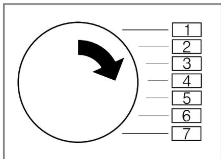
2. Нажимать **Старт/Пауза**, одновременно устанавливая программатор в положение 2.
