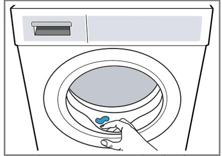
4. Оставьте дверцу прибора и дозатор моющего средства открытыми, чтобы остатки воды испарились.
