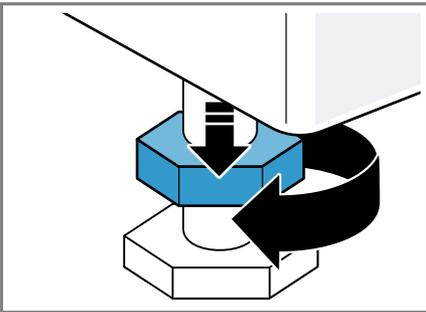
2. Чтобы выровнять устройство, поверните ножки устройства. Проверьте настройку с помощью спиртового уровня.
