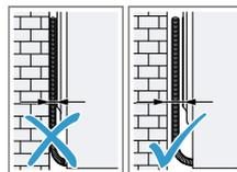
Не перетягивайте шланги в прямом эфире или в сети-кабель-связь-он между стеной и устройством.
