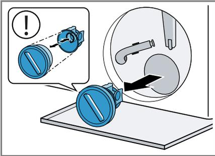
2. Очистите внутреннюю часть, резьбу крышки и корпус насоса.
