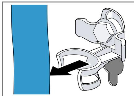
2. Отвинтите ① снимите ② все винты 4 транспортных замков с помощью рожкового ключа размера 13.
