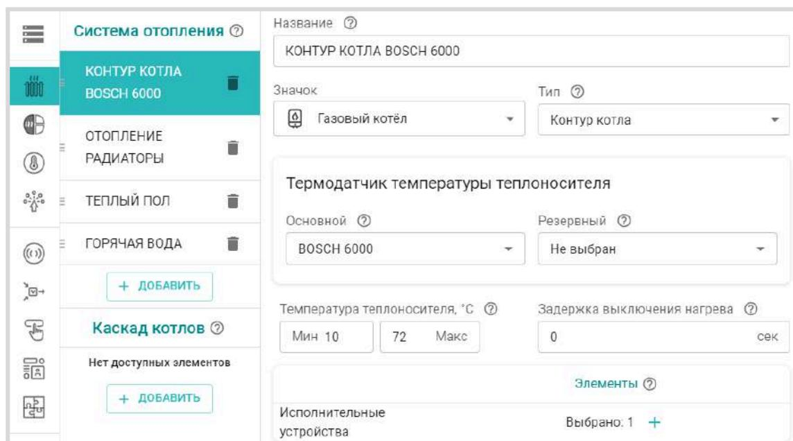
**Исполнительные устройства** – устройство, которое передает команды управления котлу:
