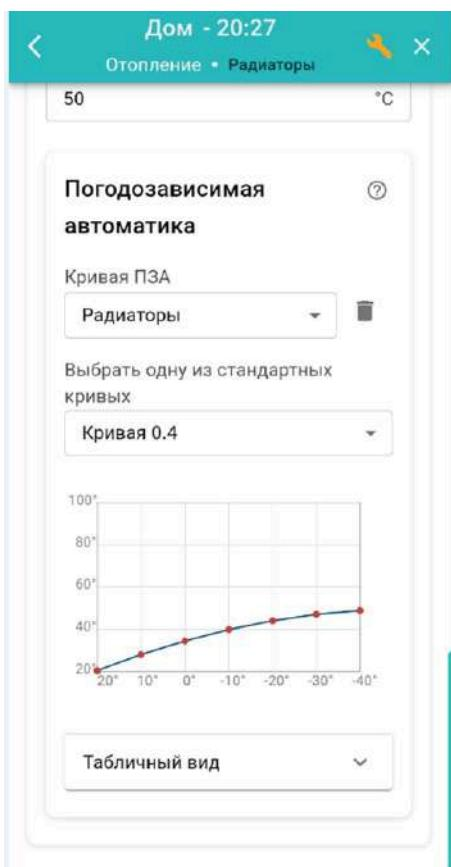
График для кривой ПЗА строится с помощью выделения точки двойным кликом и перетягивании ее относительно осей координат в желаемое место.
