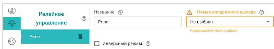
Параметр **Инверсный режим** меняет исходное состояние выхода на противоположное. Таким образом релейный нормально разомкнутый (НР) выход становится нормально замкнутым (НЗ), релейный выход НЗ становится НР, а Выход ОК в активном состоянии имеет +12В, а не 0В.
