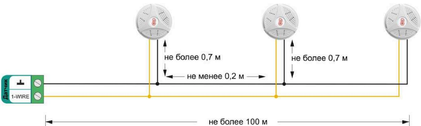
Подключение датчиков по трехпроводной схеме:
