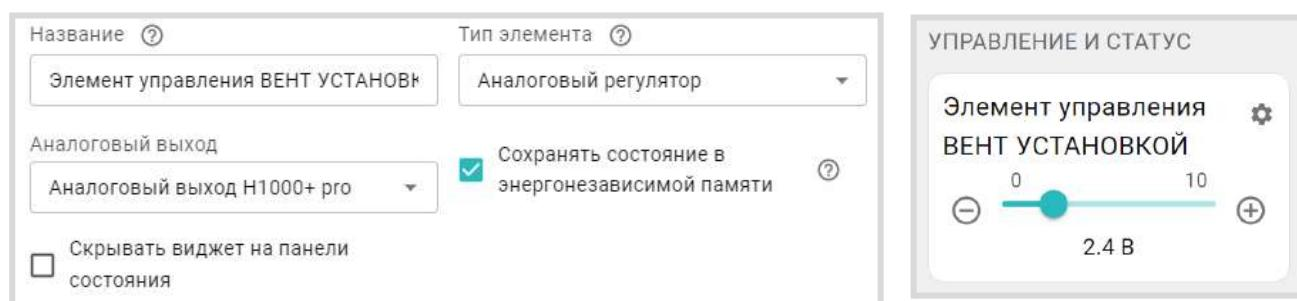
При этом в сервисе, в блоке Управление и Статус будет отображен Элемент управления аналоговым выходом 0-10В. Перемещая ползунок шкалы напряжения, можно менять напряжение на аналоговом выходе и тем самым управлять работой исполнительного устройства вручную.
