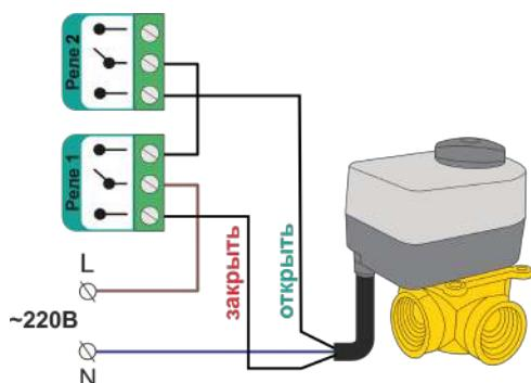
Схема подключения электропривода к выходам ОК через промежуточные реле с защитой от одновременной подачи напряжения на вывод “открыть” и на вывод “закрыть” привода:
