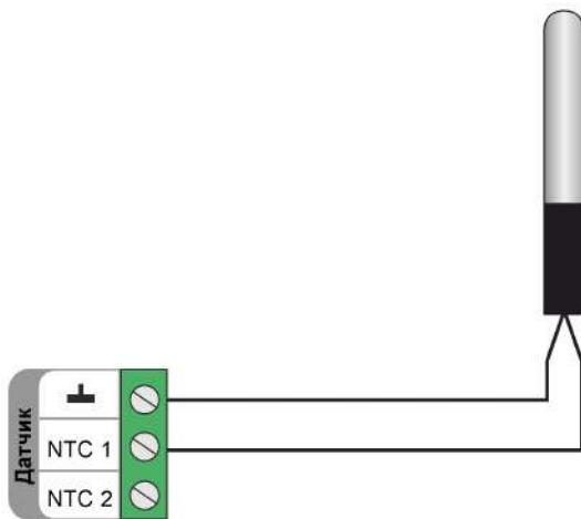
Схема подключения датчиков NTC-10 к универсальным входам/выходам Контроллера.
