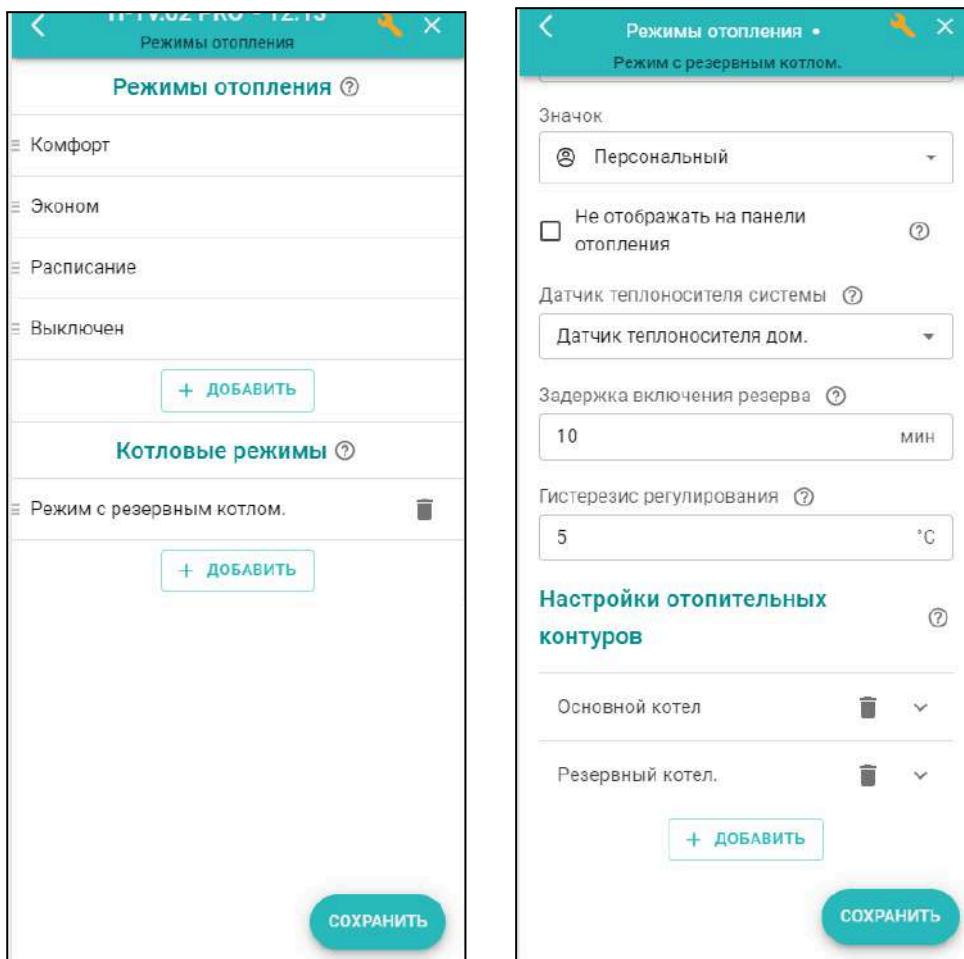
**Датчик теплоносителя системы** – источник информации о температуре подачи теплоносителя в систему отопления. Это датчик температуры, подключенный к Контроллеру и расположенный за гидроразделителем.
