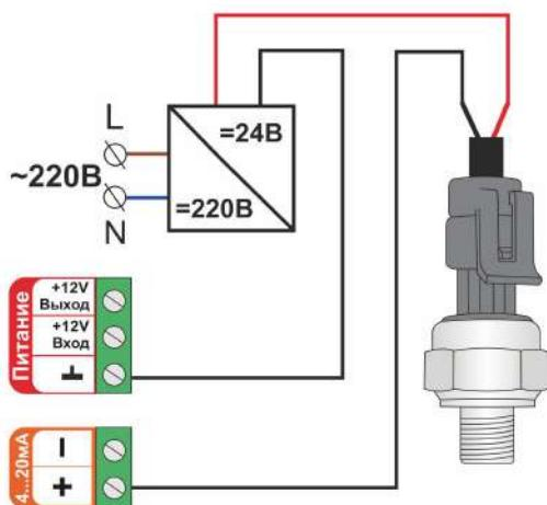
**Схема подключения пассивного токового датчика 4-20мА с диапазоном питания 9-36В**
