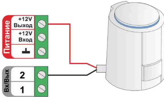
Схема подключения к релейному выходу:
