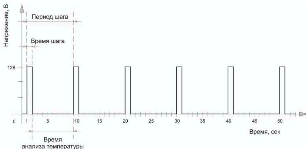
**Период шага** для управления трехходовым краном настраивается в пределах от 10 до 180 секунд. Для управления двухходовым краном (термоэлектрическим клапаном) он всегда равен 10 сек. и не может быть изменен настройкой)
