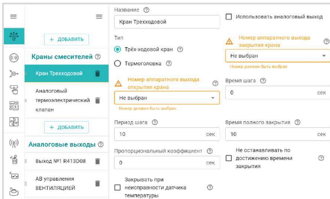
Для обеспечения плавного регулирования температуры теплоносителя в контуре необходимо импульсное управление вращением привода в сторону “открывания” и “закрывания”. При подаче каждого импульса привод перемещает шток крана на определенный угол или смещает клапан на определенное расстояние. При настройке задается **Период шага** – время между первым и следующим включением и **Время шага** – время в течении которого на привод подается напряжение.
