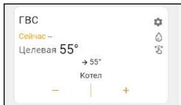
При отсутствии данных от датчика температуры, по которому производится регулирование в контуре, вместо значения температуры будет отображаться прочерк
