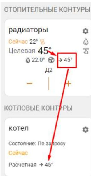
В результате такой настройки “запрос на тепло” к котловому контуру из расчетной температуры теплоносителя будет преобразован в управляющее напряжение и через аналоговый выход поступит на аналоговый вход 0-10 В котла.
