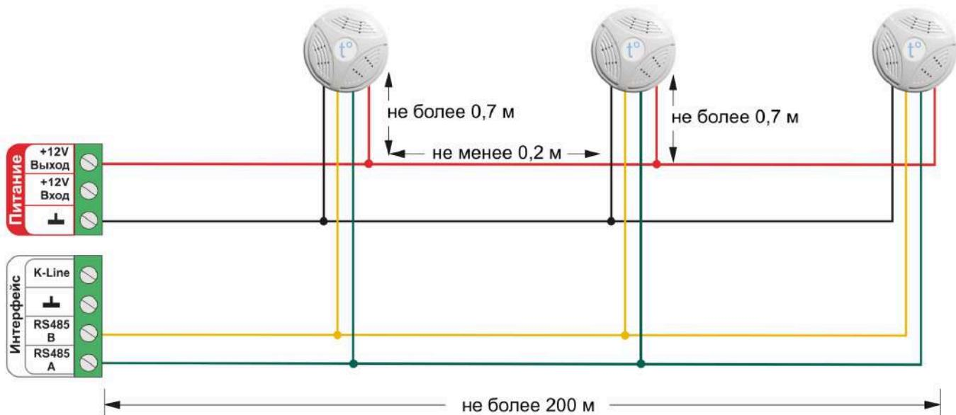
Подключение нескольких датчиков по K-Line:
