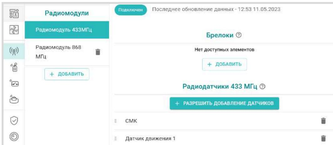
**Каждому радиодатчику 433 МГц** можно дать индивидуальное название и запрограммировать действия (реакцию) Контроллера на факт его срабатывания: отправку оповещений, выполнение действий с выходами Контроллера, запуск сценария, включение режима отопления или команды управления.
