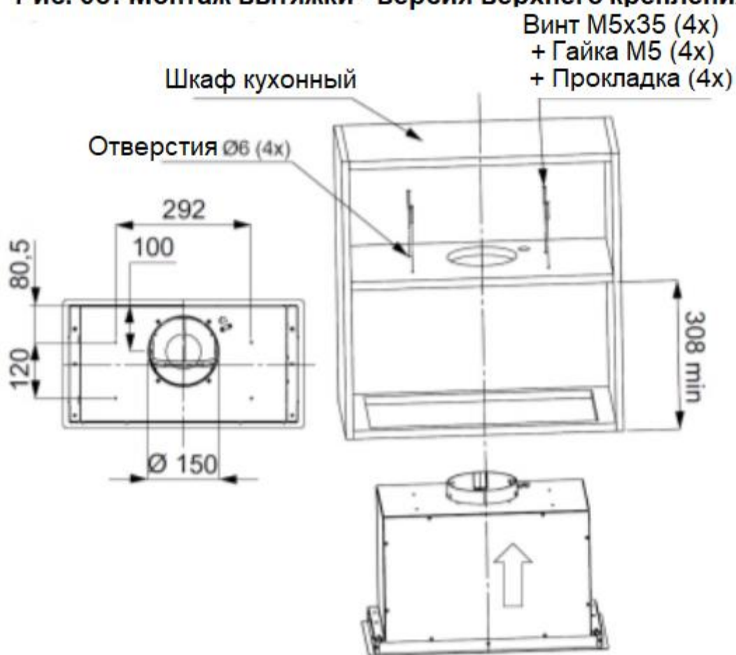
Рис. 6б: Монтаж вытяжки - версия верхнего крепления
