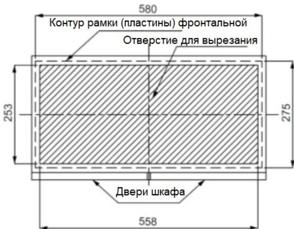
Рис. 4: Подготовка шкафа - нижняя пластина
