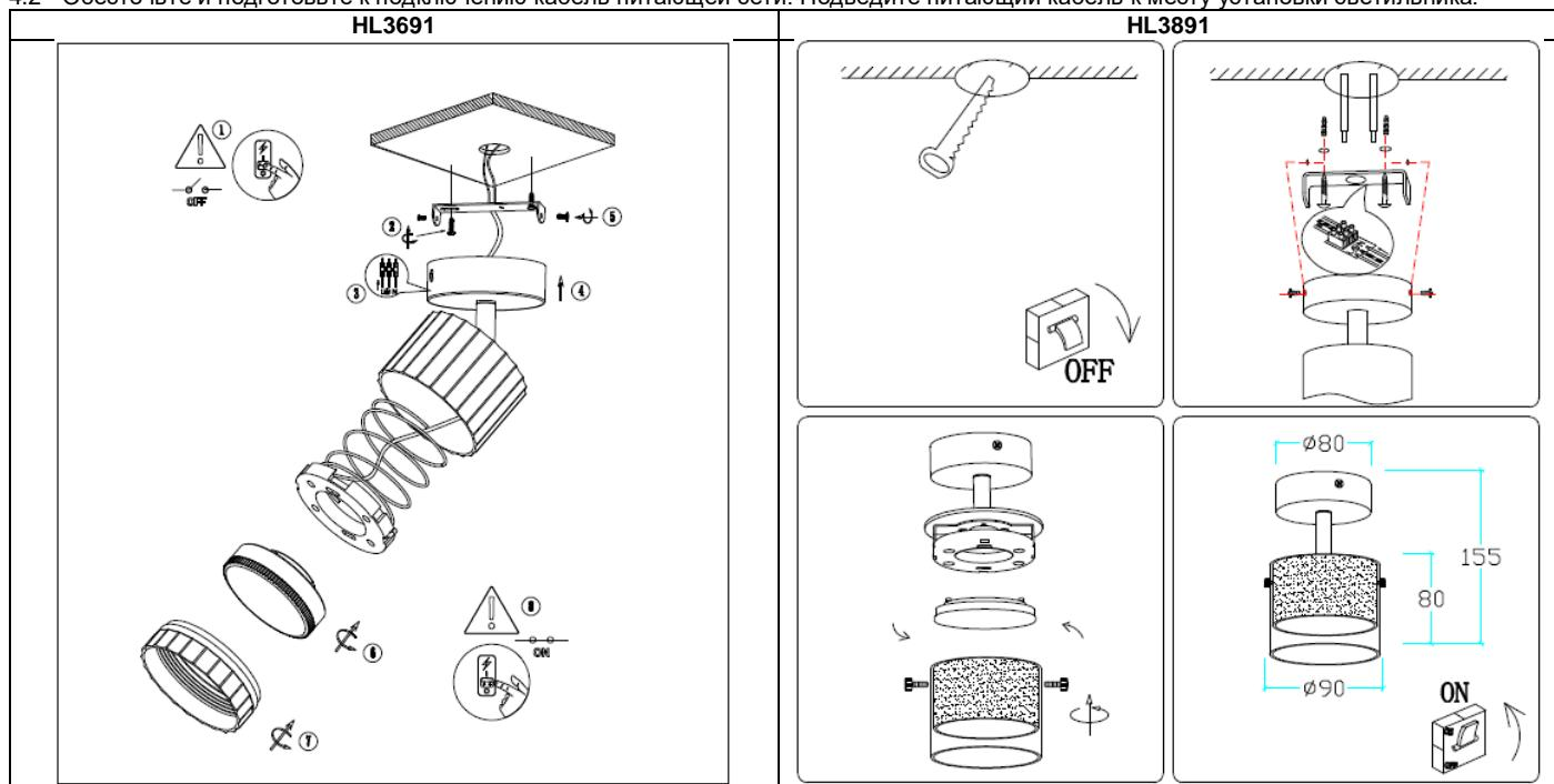
4.3 Выполните разметку потолка и подготовку монтажных отверстий в соответствии с установочными размерами светильника.
