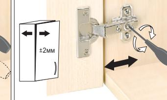
Ослабить крепежный винт и отрегулировать
