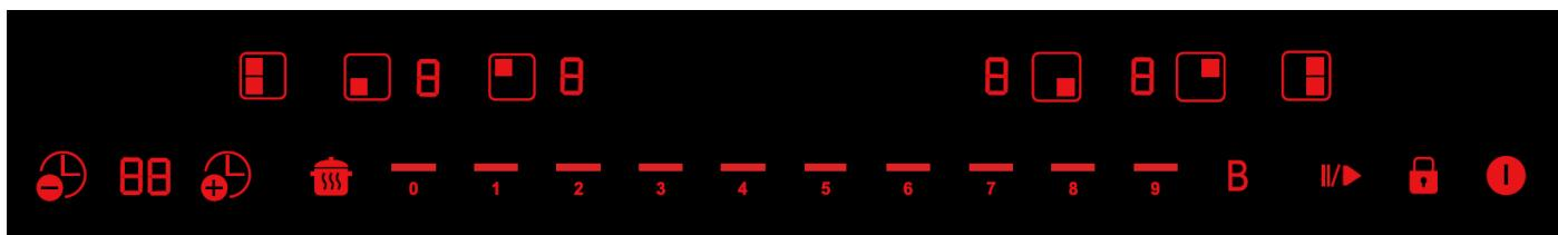
(ВКЛ/ВЫКЛ): Для включения или выключения плиты. (В режиме блокировки можно только выключить плиту).
