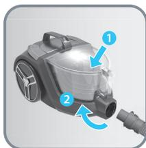
Вставьте коннектор гибкого шланга во всасывающее отверстие пылесоса и поверните по часовой стрелке до фиксации.
