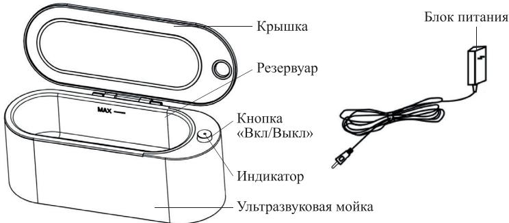
**Кнопка «Вкл/Выкл»** включает и выключает ультразвуковую мойку. Чтобы включить ультразвуковую мойку на 3 минуты, нажмите на кнопку «Вкл/Выкл». Чтобы включить устройство на 5 минут, нажмите и удерживайте кнопку «Вкл/Выкл». Когда время таймера закончится, мойка автоматически отключится. Вы можете отключить мойку раньше, для этого нажмите на кнопку «Вкл/Выкл».
