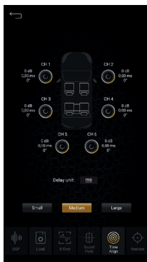
Настройка временных задержек
