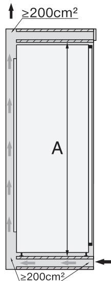
\* Заявленный расход электроэнергии рассчитан для глубины ниши 560 мм. В нише глубиной 550 мм прибор будет полностью работоспособен, однако расход электроэнергии немного увеличится.
