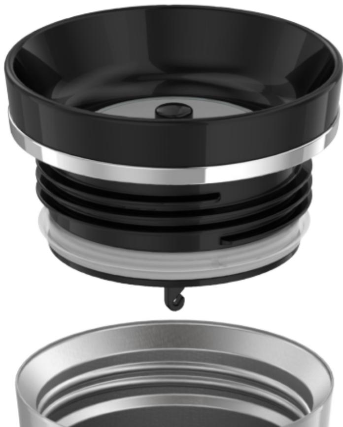
Крышка-пробка гигиенична, она полностью разбирается для очищения всех деталей. Для этого поверните фиксатор против часовой стрелки и поочередно снимите прокладку фиксатора, уплотнительный диск и прокладку-кольцо, как показано на рисунке. Тщательно вымойте все детали с моющим средством для посуды и просушите их. В обратном порядке соберите детали крышки-пробки. Проверьте правильность установки всех съемных деталей, т.к. они обеспечивают герметичность изделия.
