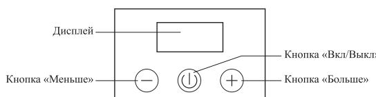
Нажатие на кнопку «Вкл/Выкл» включает и выключает прибор. Кнопками «Больше» и «Меньше» можно настроить необходимую температуру нагрева. Температуру можно установить от 30 до 120 °C.
