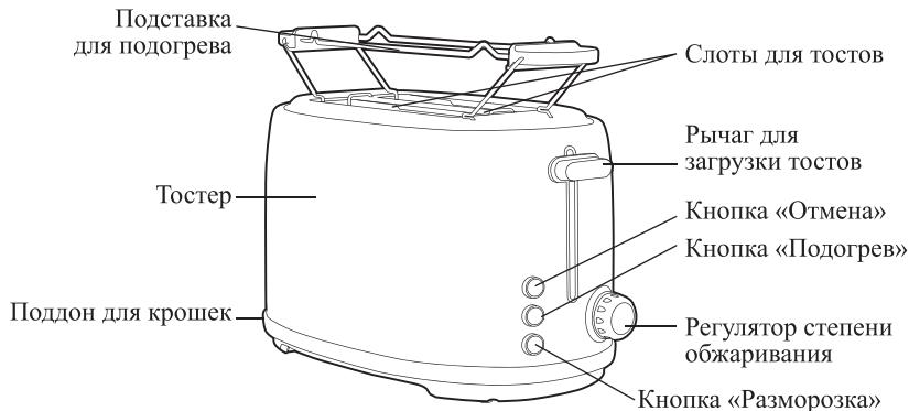
С помощью *регулятора степени обжаривания* настраивается степень обжарки тостов от «1» до «6». «1» — означает минимальное время и легкую (светлую) обжарку, «6» — максимальное время и сильную (темную) обжарку.
