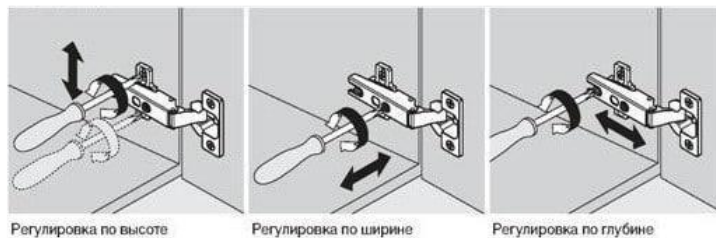
Схема регулировки дверных петель
