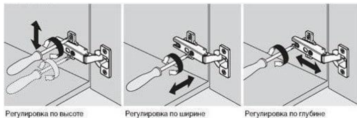
Схема регулировки дверных петель
