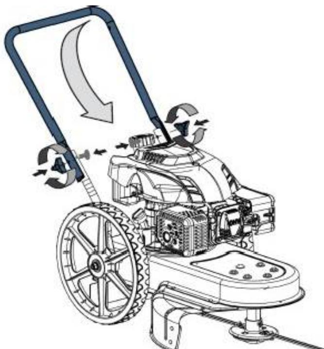
Соедините верхнюю и нижнюю части рукоятки управления и закрепите болтами и барашковыми гайками.
