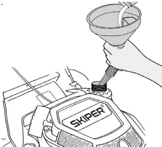
Мы рекомендуем использовать высококачественный неэтилированный бензин высокой очистки с октановым числом не менее АИ-92. Не храните бензин до начала использования более 30 дней
