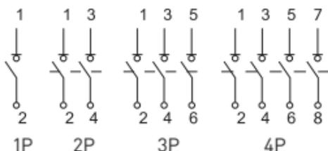
Рис. 2 Типовые схемы подключения
