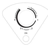
Возможны режимы охлаждения и замораживания В положении REFRIGERATOR включается режим охлаждения
