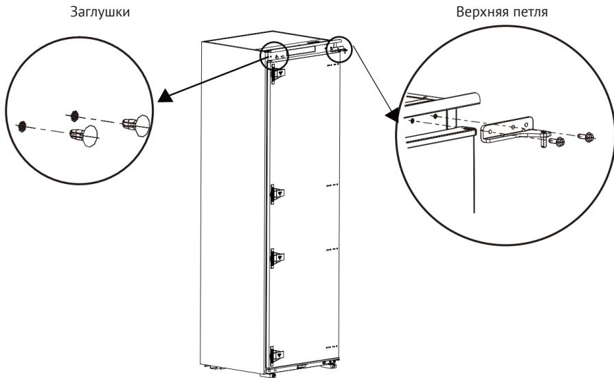
3. Снимите дверь холодильной камеры освободив её от скотча, аккуратно приподнимая и выдвигая на себя. Открутите нижнюю дверную петлю и снимите нижние заглушки с противоположной стороны двери.
