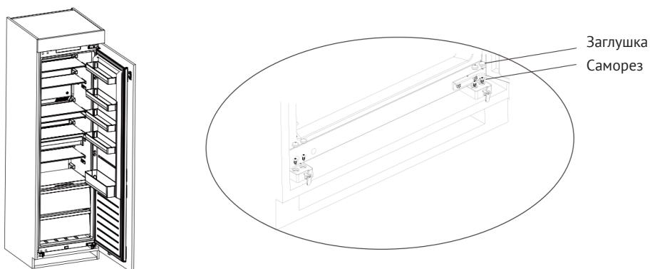
4. Прикрепите верхний козырек к шкафу при помощи саморезов, затем закройте их заглушками. Проверьте правильность закрывания верхних и нижних дверных панелей.
