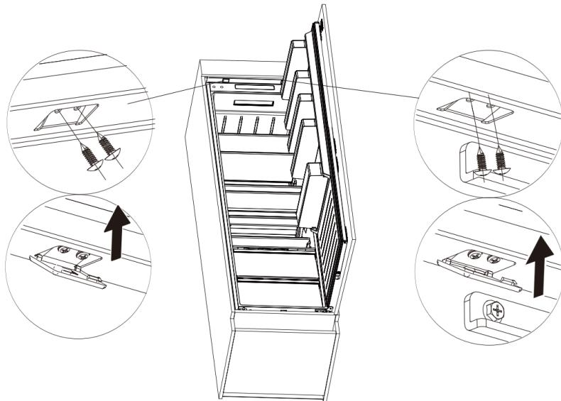
5. Откройте дверцу установочного шкафа на максимальный угол, дверцу холодильника - до соответствующего положения. Выдвиньте верхнюю и нижнюю крепежные планки наружу из-за двери до упора и прикрутите их при помощи саморезов к мебельному фасаду. Затем закройте отверстия заглушками.
