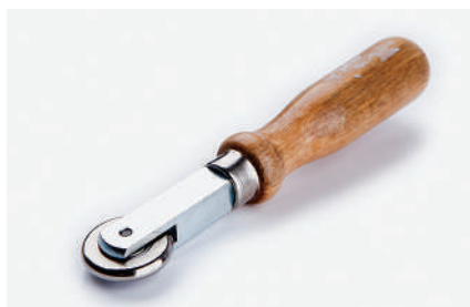
Прикаточный ролик Используется при работе в углах.
