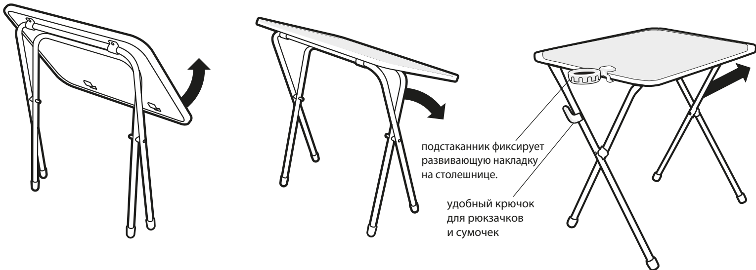
Рис. 2 Схема раскладывания стола
