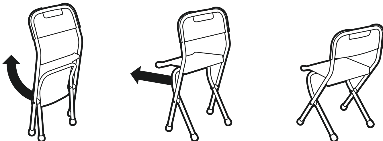
Рис. 3 Схема раскладывания стула с пластмассовым сиденьем
