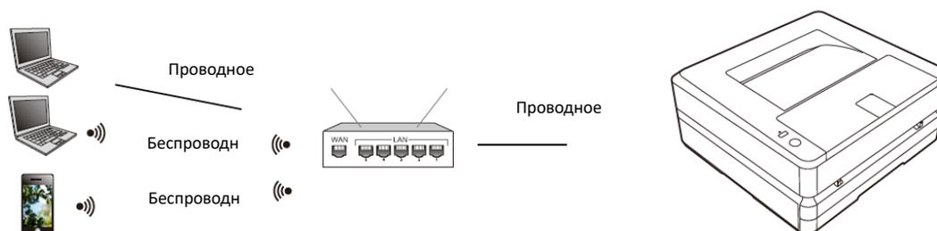
1. Подключите принтер к беспроводному маршрутизатору с помощью сетевого кабеля
