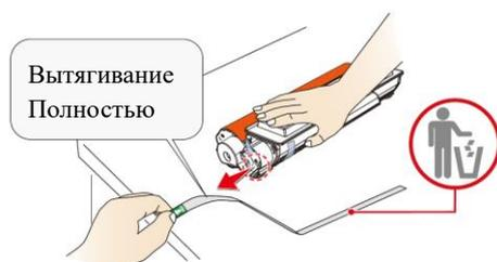
**С.** Снимите защитную клейкую ленту и удалите защитную бумагу.
