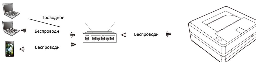
1. Выполните беспроводное подключение принтера к беспроводному маршрутизатору
