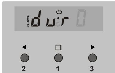
gewünschte Betriebsdauer mit den Tasten **3** und **2** einstellen (siehe Halbautomatischer Betrieb).
