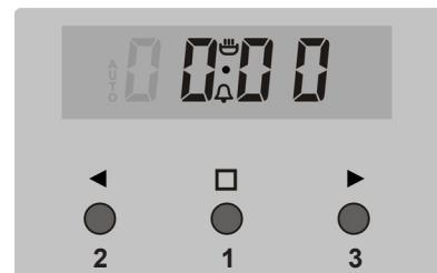
Zeitdauer am Timer mit den Tasten **3** und **2** einstellen. Die eingestellte Zeitdauer ist an der Anzeige zu sehen und die Betriebsfunktion
