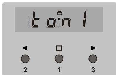
Mit dem Taste **2** wählen Sie den entsprechenden Ton im Bereich von 1 bis 3 aus.
