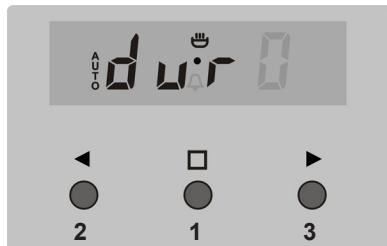
gewünschte Betriebsdauer mit den Tasten **3** und **2**, im Bereich von 1 Minute bis zu 10 Stunden einstellen.
