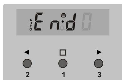
Abschaltzeitpunkt (Betriebsende) mit den Tasten **3** und **2** einstellen; der kann nur um maximal 23 Stunden und 59 Minuten vom aktuellen Zeitpunkt entfernt sein,
