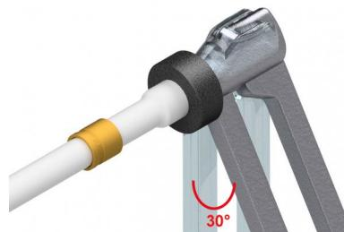
Отрежьте часть трубы, которая имеет неправильную форму после расширения, и выбросьте несоответствующий кусок трубы. Замените расширители, которые повреждены или не дают правильной формы расширяемой трубы. Неисправный расширитель может вызвать проблемы с уплотнением трубы и фитинга. Смажьте конус расширителя, если ход конуса затруднен. Если после расширения на трубе есть трещины или повреждения, удалите повреждённый участок и повторите действия по расширению трубы заново.
