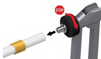
Установите монтажную гильзу на трубу, убедившись, что маркировочная полоса находится напротив среза трубы и что между срезом трубы и самой гильзой есть двойное расстояние по сравнению с размером гильзы.
