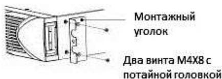
Рис.3 Установка монтажных уголков
