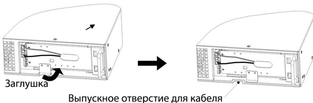
Рис. 2а Снятие кабельной заглушки ИБП.
