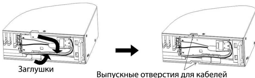
Рис. 2б Снятие кабельных заглушек ДВББ.
