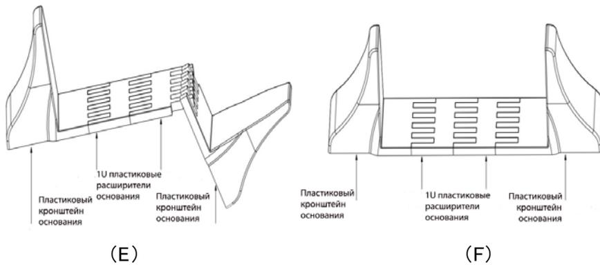
Рис. 9. Расширение пластмассового основания.
