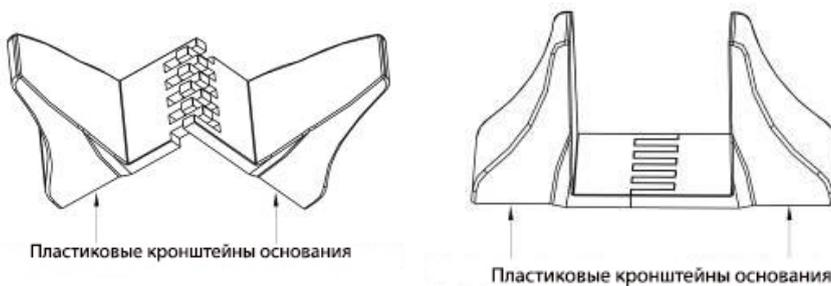
Рис. 8 Установка пластикового основания
