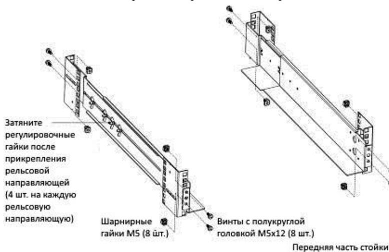
Рис. 2 Закрепление направляющих
