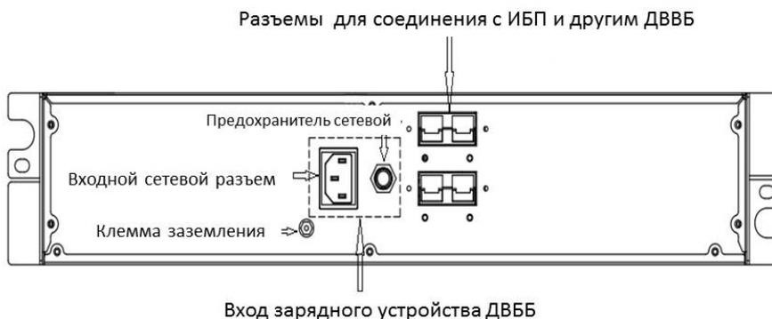
Рис. 8 Задняя панель ДВББ.
