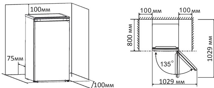
**⚠ ЗАПРЕЩАЕТСЯ** устанавливать витрину в нишу или встраивать её в мебель, а также перекрывать зазор между стеной помещения и задней стенкой ВХ.
