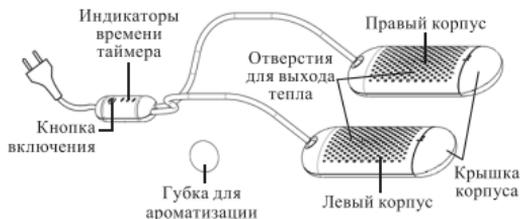
**Кнопка включения** включает сушилку и циклически переключает таймер по порядку — 9, 6 и 3 часа. Когда установлен таймер на 3 часа, последующее нажатие на кнопку выключит сушилку.
