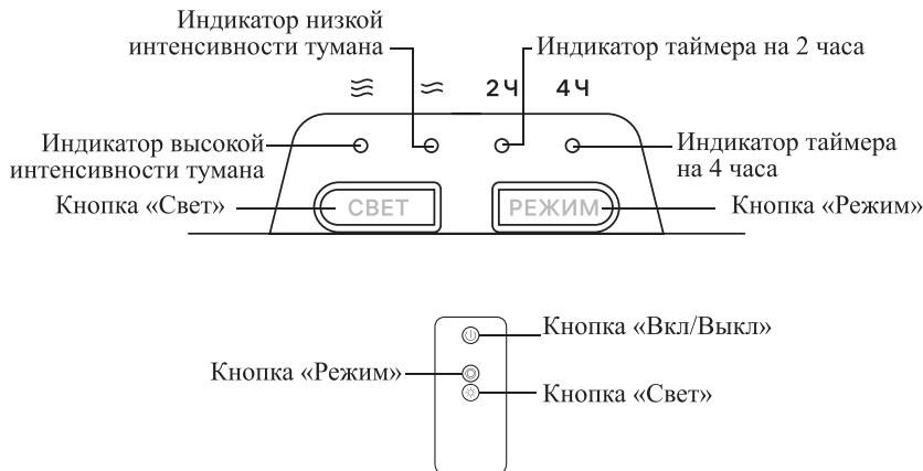
**Кнопка «Режим»** на панели управления циклически меняет высокую и низкую интенсивность увлажнения, устанавливает таймер на 2 или 4 часа, а также включает и выключает прибор. При выборе интенсивности увлажнения, а также при установке таймера на 2 или 4 часа будет гореть соответствующий индикатор.
