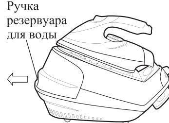
Следует выливать воду из резервуара и выпаривать остатки воды из бойлера после каждого использования устройства и не давать воде застаиваться в резервуаре, чтобы не допустить ее порчи и цветения.
