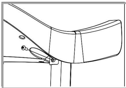
4. С помощью отвертки и винтов М5\*14 закрепите декоративные кожухи по обеим сторонам основания корпуса.
