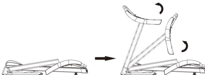
2. Закрепите стойки с помощью шестигранного ключа 5#, винтов M8\*22 и гаек. Зафиксируйте положение шайб и гаек с помощью винтов M8\*45.
