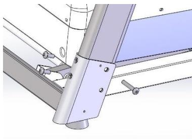
3. Зафиксируйте положение стоек с помощью шестигранного ключа 5# и фиксирующих шайб М8\*25.
