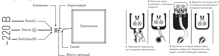
Рис.1. Схема подключения светильника SPO-6-36...-А (с клеммником для БА1).
