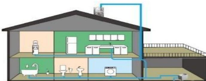
**Рис. 2. Схема водоснабжения насосной станции S-BOX4-30**
