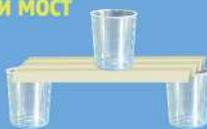
Объяснение: когда лист сложен веером, создаётся конструкция, у которой вес стакана распределяется равномерно по всему импровизированному мосту. В первом же случае вес стакана осуществляет давление лишь на площадь соприкосновения с листом.
